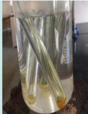
۵ لوله آزمایش حاوی روغن کرچک، روغن کنجد، روغن زیتون، روغن آفتابگردان و امگا ۳ در حمام آب داغ
